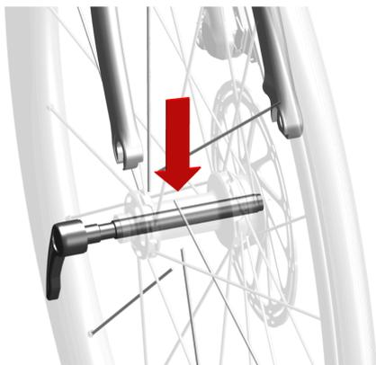
3. Das Laufrad durch Ziehen nach unten entnehmen.
