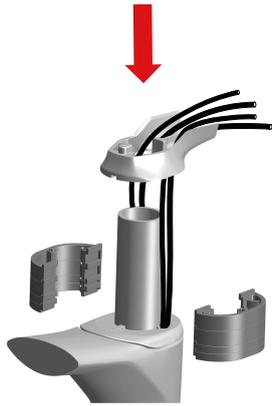
5. Bei Verwendung eines OC-Vorbaus mit unterem Deckel für die Verkabelung diesen einsetzen. Wenn gewünscht, die passende Anzahl von ovalen 5/10 mm ICR-Spacern (max 40 mm hoch) einsetzen.
