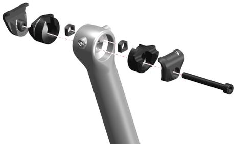
4. Die Sattelklemmung auf der Sattelstütze montieren.
