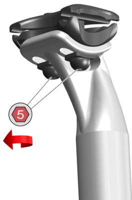
1. Die Klemmplattenbefestigungsschrauben lösen.
