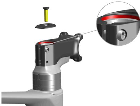
2. Darauf achten, dass sich das Gabelschaftrohr über der oberen Vorbauklemmschraube befindet und dann den oberen Vorbaudeckel anbringen.
