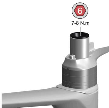
1. Bei passend eingekürztem Gabelschaft den Carbon-Expander mit dem empfohlenen Anzugsdrehmoment montieren.
