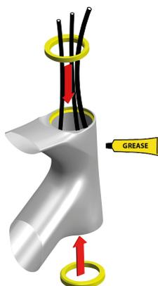
2. Montagefett auf das obere und untere Steuerrohrgehäuse und die Lager aufbringen und diese einsetzen.
