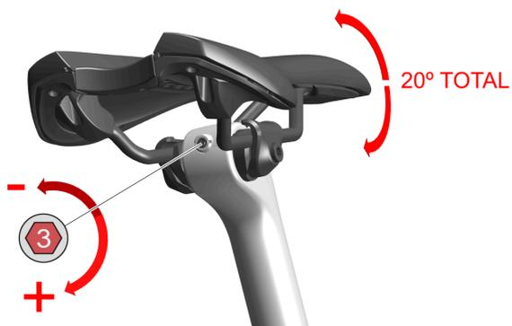
2. Zum Erhöhen der Sattelneigung die Sattelneigungsschraube lösen, zum Verringern die Sattelneigungsschraube anziehen.
