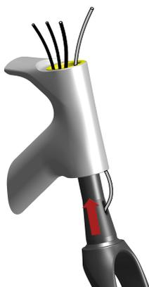
3. Die Gabel einschließlich durchgeführter Vorderradbremseleitung einsetzen.
